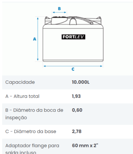
Figura 26 – Dimensões do tanque de 10.000L.
